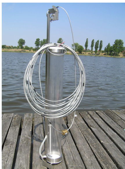
Fot. 2. Batometr (objętość 5l, wysokość 1 m) zastosowany do poboru prób wody w profilu pionowym Jeziora Durowskiego.
